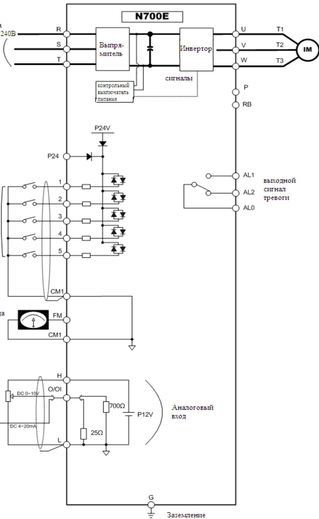
Рис.2-3 Схема подключения клемм
