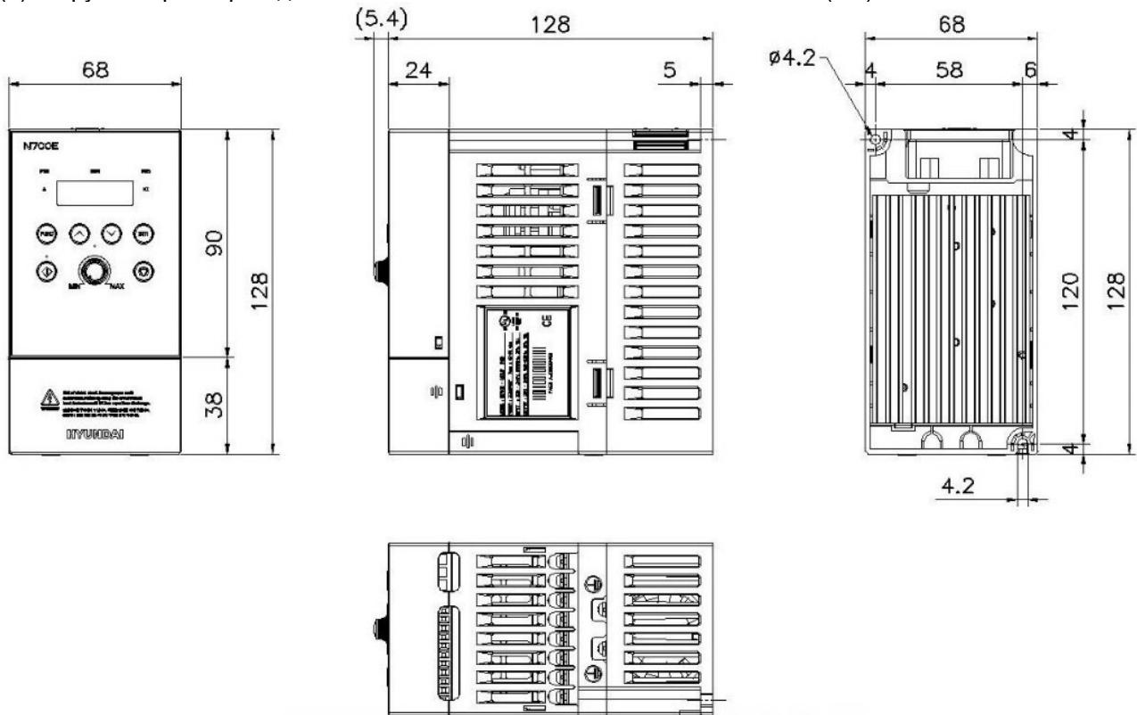
(2) Наружный размер моделей N700E-015SF/004HF/007HF/015HF/022SF/022LF/022HF (мм).
