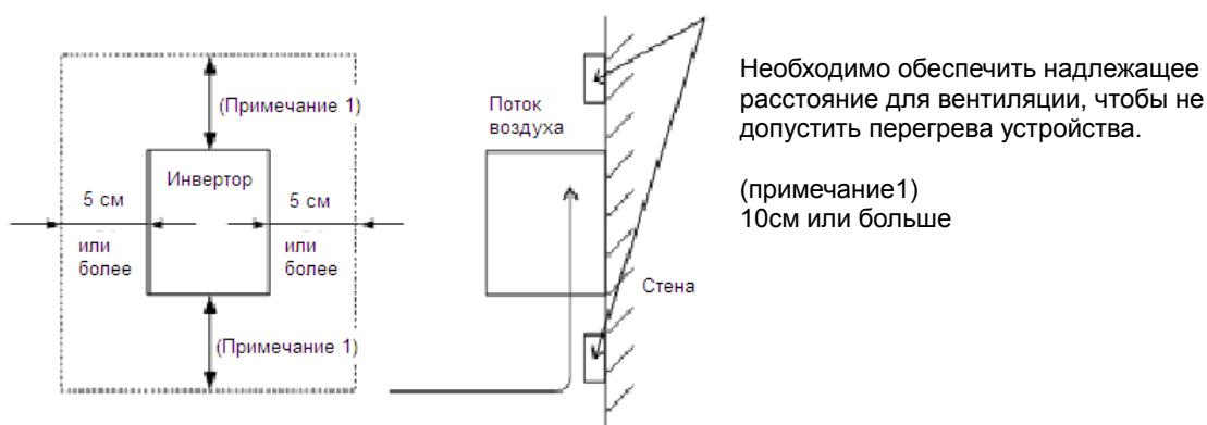
Рис. 2- Поверхность для установки инвертора
