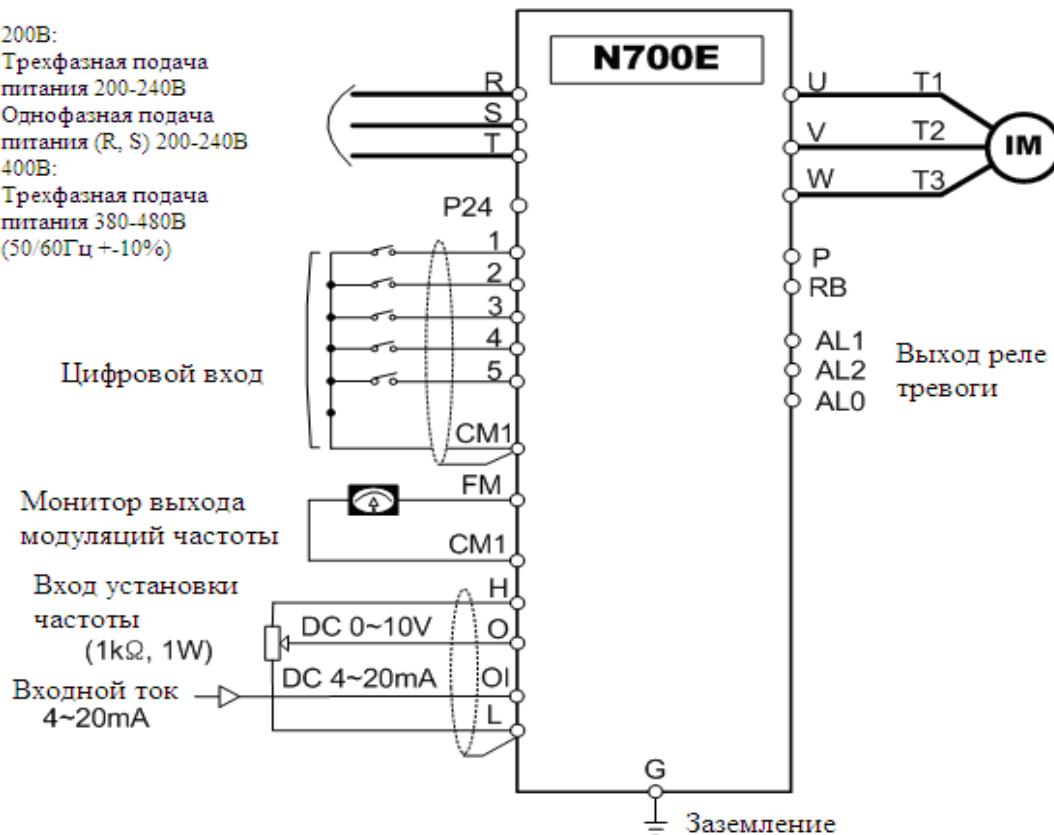
Рис. 3-1 Схема установки команд с помощью клемм управления
