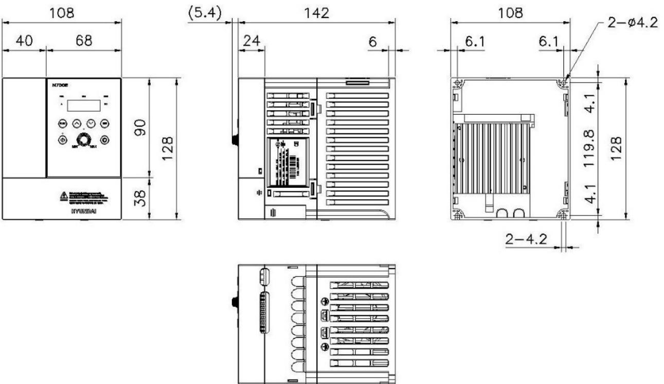
(3) Наружный размер моделей N700E-037LF/037HF (мм).
