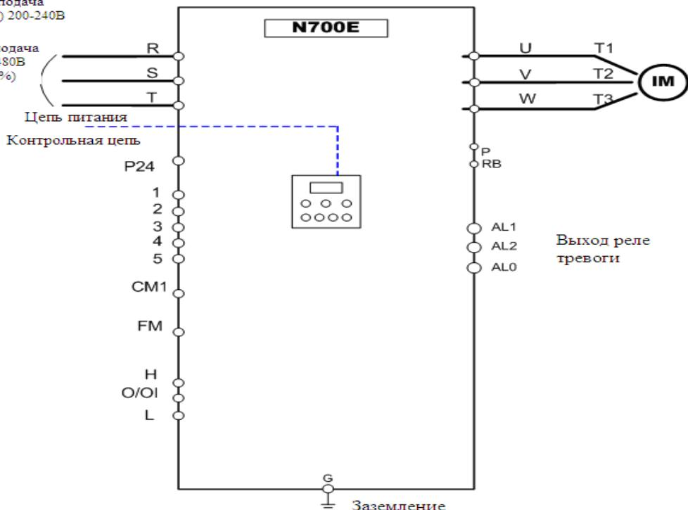
Fig 3-2 Схема установки с цифровым пультом оператора
