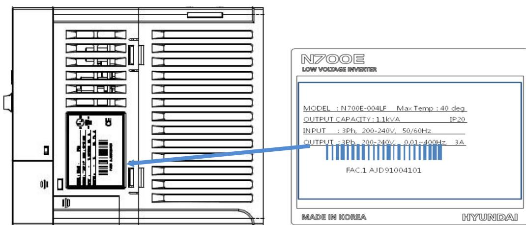
Рис.1-2 Содержание таблички технических характеристик
